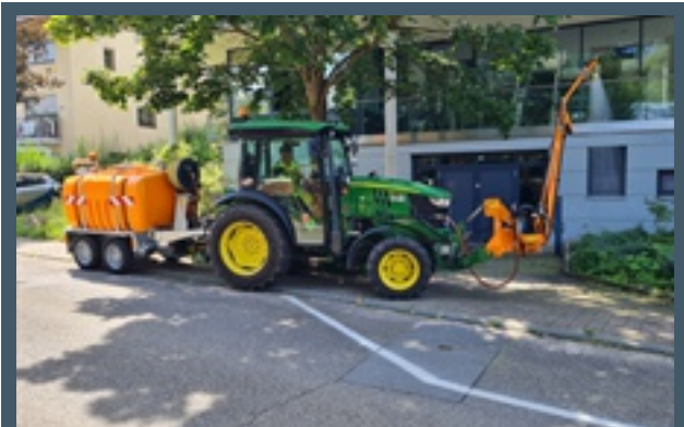
Gemeindlicher Kleintraktor mit Gießanhänger und Gießarm
